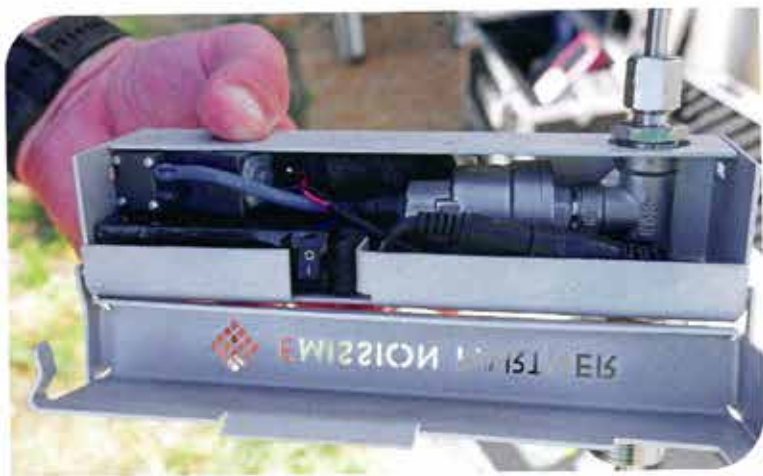
Blick in das Innere des Gerätes, das dem Anwender verborgen bleibt. Zentrales Bauteil ist die Gaspumpe.
