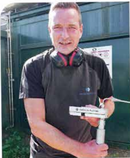
Matthias Wawra von Emission Partner hat mit seinem Team den Formaldehyd-Schnelltest 2.0 entwickelt. Das kompakte Gerät kann direkt auf der Biogasanlage eingesetzt werden.
