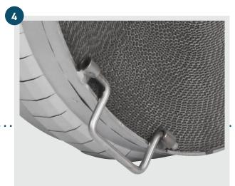
Den Katalysator bis zum Anschlag vor das Rohrbündel des Wärmetauschers einschieben. Falls der Widerstand zu groß ist, Katalysator wieder herausholen, die LFK flacher drücken und den Vorgang wiederholen.
