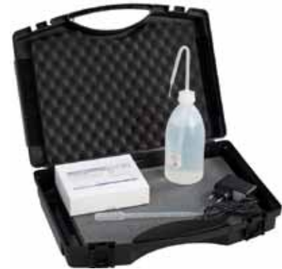
Handliches Messgerät zum ausschließlichen Messen der Formaldehydemissionen an einem Stationärmotor.
